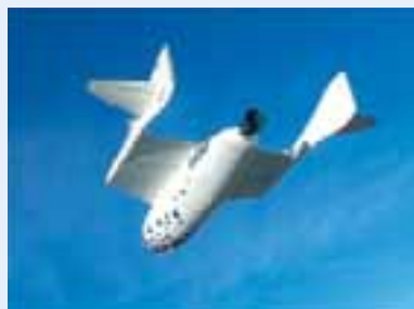
全長5m、総重量3トン、マッハ3を誇る弾道軌道飛行に成功したスペース・シップ・ワン(3人乗り)
